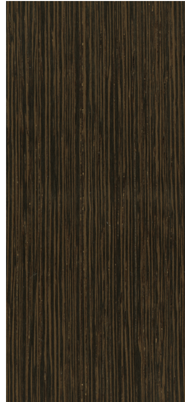
Débit sur faux quartier
